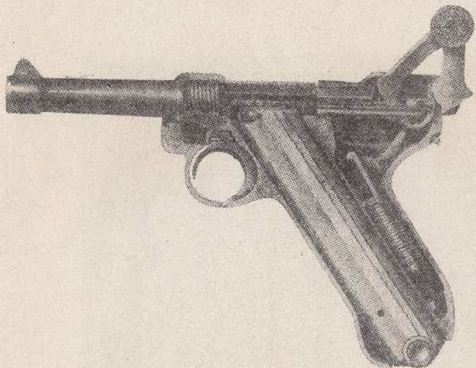
M-1908 の断面図 薬室に実包が送り込まれ、發針 が引かれている。(右図) 遊底が引かれ、銃身が後退した所。 (下図)
