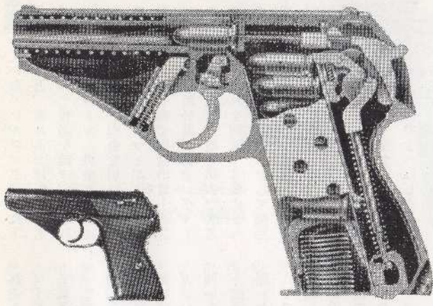
モーゼル HSC ダブルアクション・オートマチック 左は外観・右はその断面
